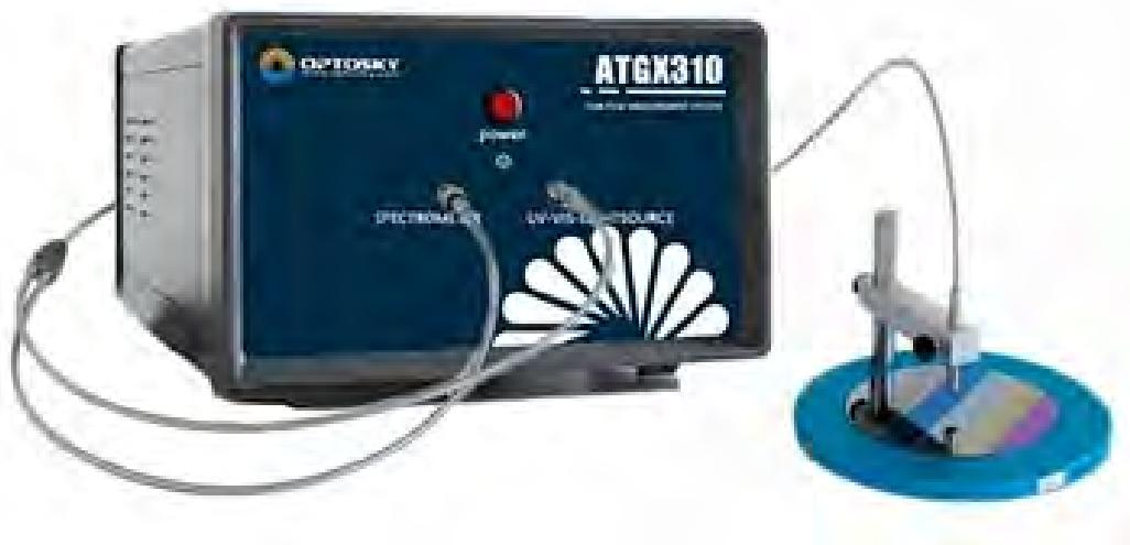
Падающий свет с длинами волн от 200 до 1700 нм по вертикали освещает поверхность тонкой пленки. когда происходит пропускание тонкой пленки, ATGX310 может использовать свет, отраженный через верхнюю и нижнюю границы тонкой пленки, для создания наложенной интерференционной картины, расстояние между синусоидальными волнами рисунка в сочетании с показателем преломления материала, может использоваться для расчета толщины материалов.
